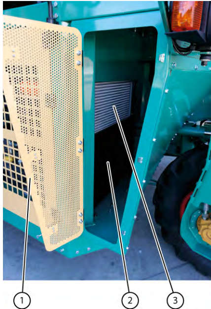
Fig. 97 Nettoyer les radiateurs moteur
