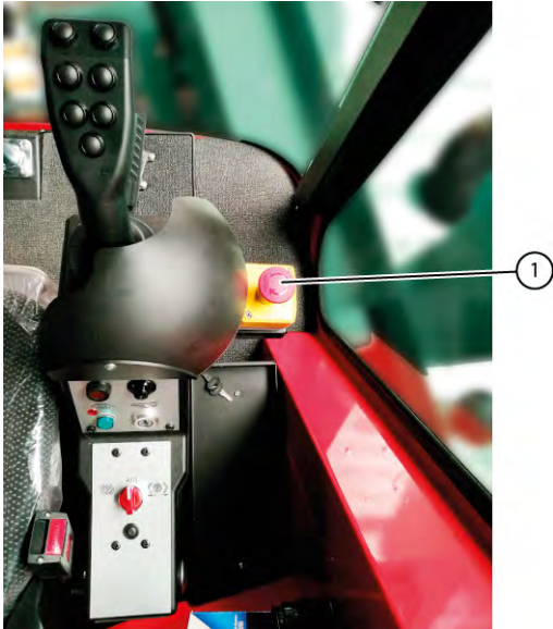
Fig. 35 Emplacement de l'arrêt d'urgence
