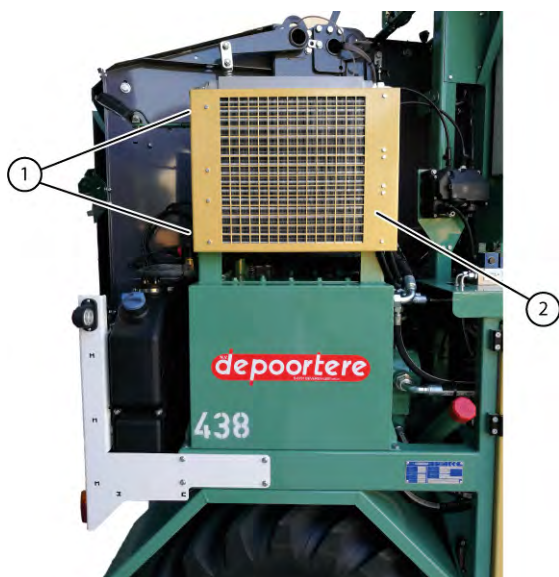
Fig. 98 Nettoyer les radiateurs de la clim et de l'huile hydraulique
