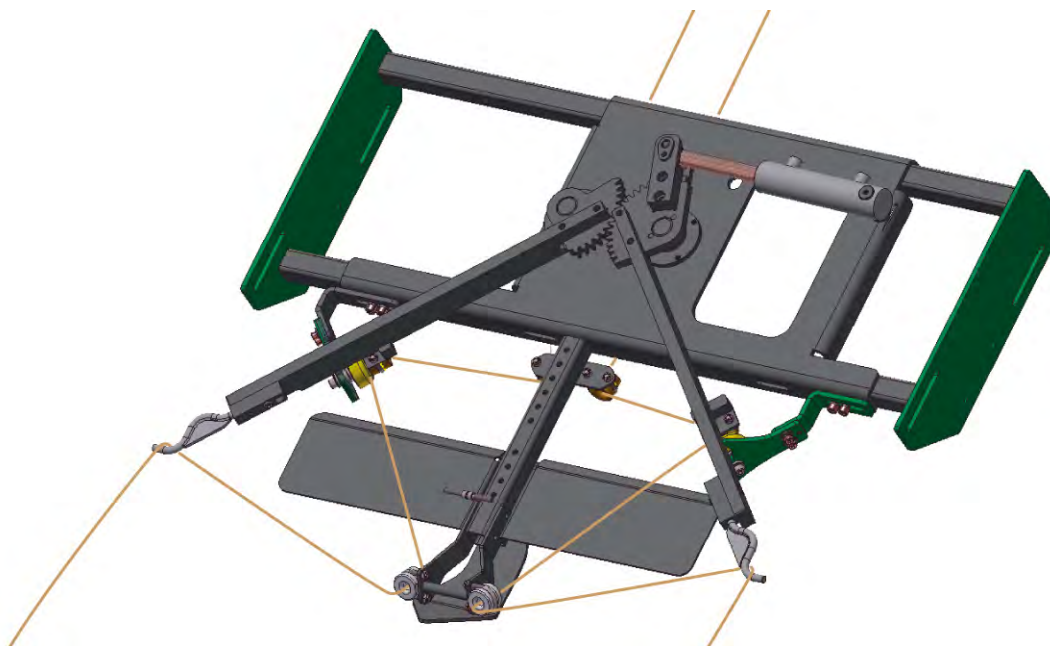
Fig. 27 Système de liage ficelle lors de son fonctionnement ouvert
